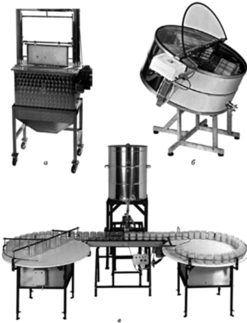
Рис. 12.3. Технологічне обладнання для відкачування меду: а — установка для розпечатування стільників; б — медогонка; в — лінія для фасування меду
