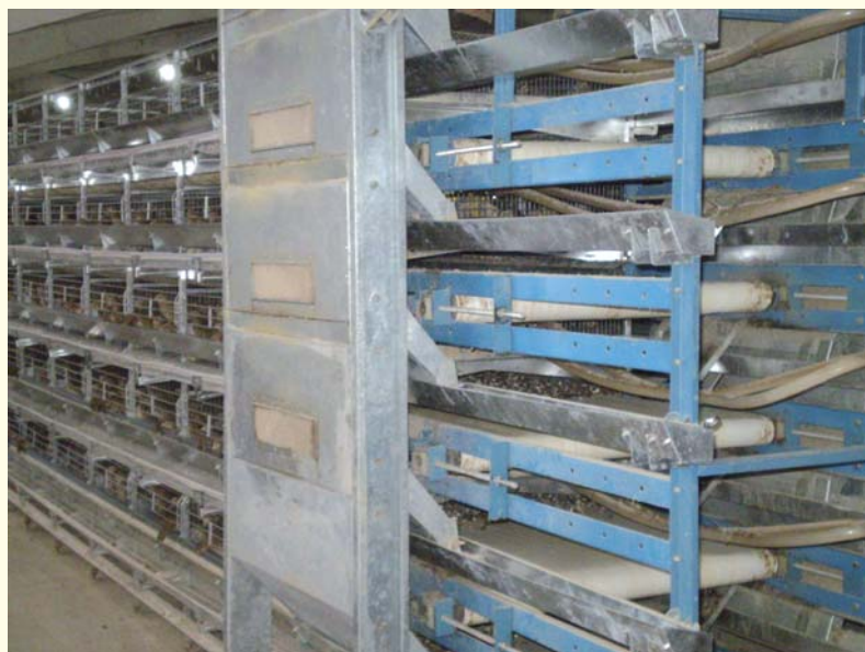
Рис. 3.9 – Мобільний бункер кормороздавачального обладнання кліткового для утримання перепелів ОКП.
