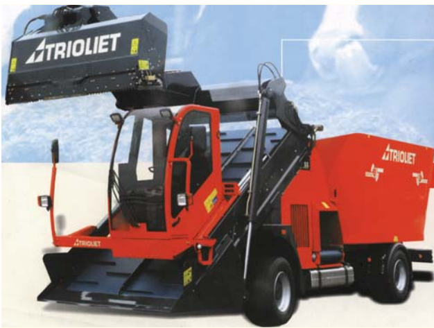
Рисунок 1.6 – Навантажувальний робочий орган на самохідному фермському комбайні „Triotractor”.
