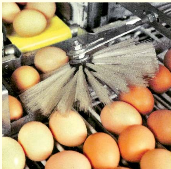
Рис. 3.18 – Пристрій для запобігання мікротріщин шкаралупи яєць.
