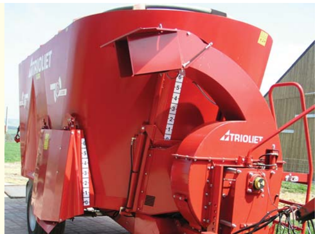
Рисунок 1.7 – Кормозмішувач-роздавач «Solomix P» з органом для видування соломи на підстилку фірми «TRIOLIET».
