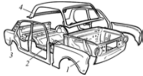
Рис. 9.8. Кузов легкового автомобіля: 1 — передні крила; 2 — підлога (днище); 3 — боковина; 4 — дах
